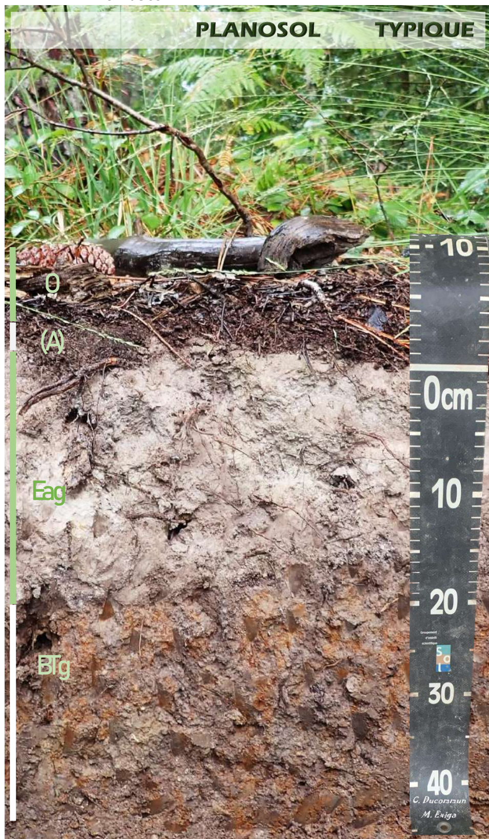
Figure 2, exemple de Planosol ; Séquence d'horizons : O (litière) ; A organique de surface (ici sporadique) ; Eag horizon éluvié (appauvri en fer et en argile) blanchi (blanchi) hydromorphe ; BTg horizon non appauvri (voire légèrement enrichi en fer et en argile).
