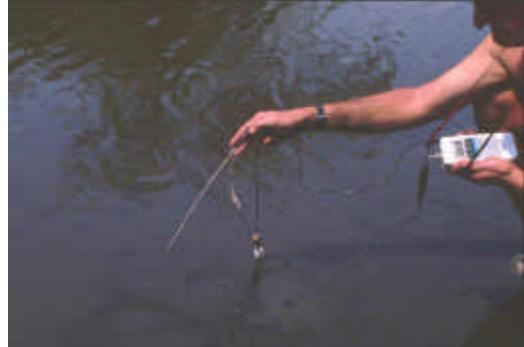
Mesure de l'oxygénation de l'eau à l'aide d'un oxy-mètre portable.
