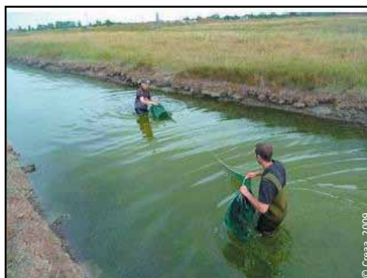
Figure 4 : Verveux de fond à double poche et pose lors d'un échantillonnage en fossé saumâtre en Seudre.
