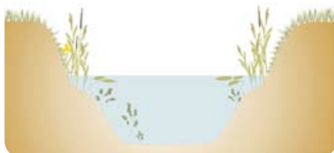
Fig.23. Fossé avec berges hautes : curage du vieux fond et maintien d'une rupture de pente favorable aux hélophytes dans le but d'éviter la poursuite de l'élargissement du fossé.
