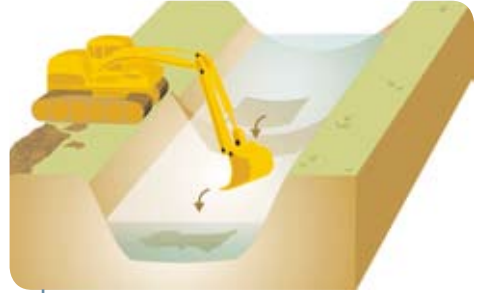
Fig.29. Réensemencement à la pelle mécanique de la zone curée par épandage de la crème de vase ancienne.
