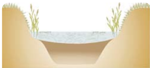
Fig.22. Conservation d'une ceinture végétale sur les petits fossés lors du curage.
