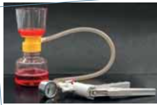
Kit de filtration de terrain (source FMA).
