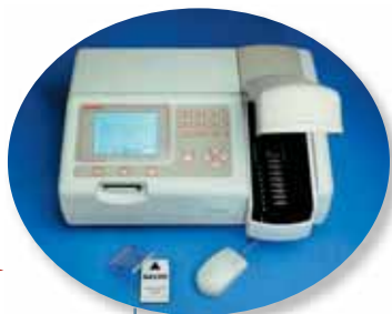
Spectrophotomètre d'usage mixte terrain-laboratoire (source FMA).
