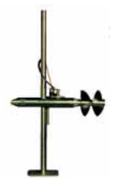
Sonde de courantomètre à hélice
