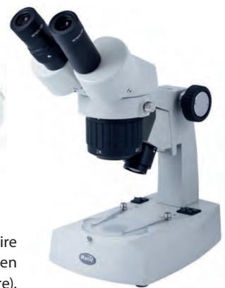
Loupe binoculaire (détermination en laboratoire).
