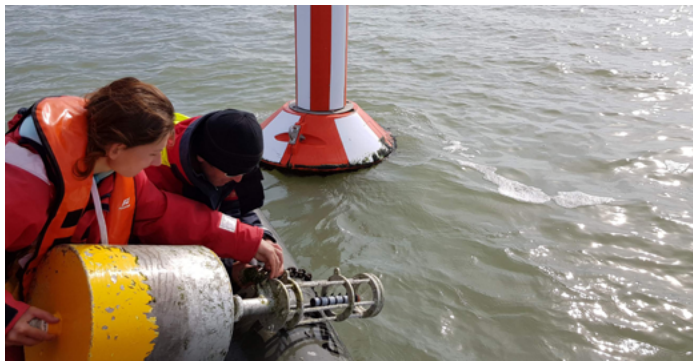
Changement de sonde sur la Sèvre niortaise, station côtière (© RNN baie de l'Aiguillon)
