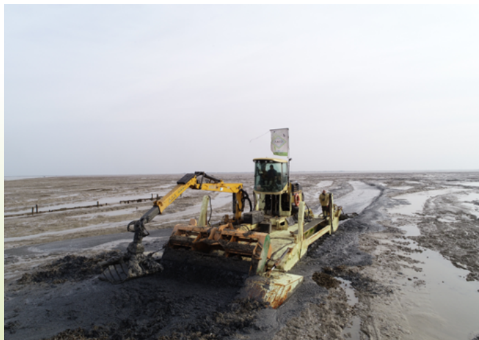
Barge flottante à vis sans fin munie d'un broyeur frontal de 3 mètres alimenté par un moteur de 500 chevaux. (© RNN baie de l'Aiguillon)
