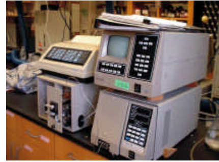
Figure 19 : chaîne d'analyse HPLC (haute pression en phase liquide) de laboratoire pour le dosage de composés organiques (pesticides, PCB, etc.). Des protocoles très rigoureux (séparation-extraction, concentration) doivent être employés pour réaliser des dosages sur cet appareil, avec des seuils de détection très faibles.
