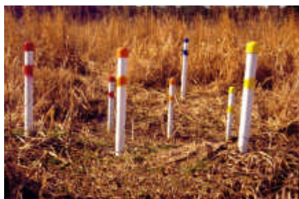
Figure 1 : Utilisation de tubes piézométriques pour la mesure de niveaux d'eau dans un sol tourbeux. Ces tubes poreux sont enfoncés verticalement. L'eau du sol percole dans le tube et se maintient en équilibre hydrostatique avec la pseudo-nappe. Des échantillons peuvent aussi être prélevés à l'aide d'une pompe.
