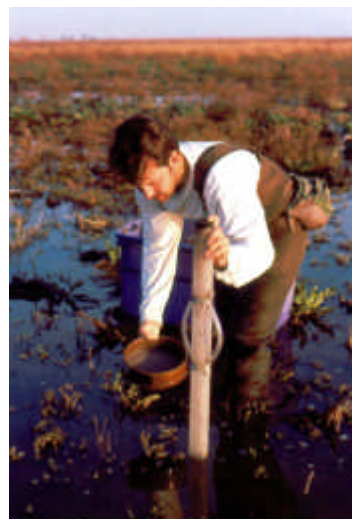
Figure 11 : pour une analyse des invertébrés benthiques, le prélèvement des premières couches de sédiments peut s'effectuer par simple carottage, suivi d'un passage sur un tamis fin.
