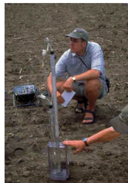
Figure 14 : La mesure de la hauteur de la nappe de sub-surface peut être enregistrée par des piézomètres équipés de centrale d'acquisition automatique.
