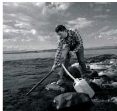
Figure 13 : les modes de prélèvement d'eau varient selon les conditions de milieu et les quantités nécessaires : prélèvement manuel avec bouteille en eaux calmes ; prélèvement de forts volumes avec pompe à main en milieu turbulent.
