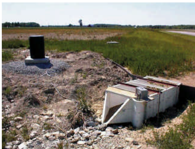
Figure 12 : Site d'échantillonnage équipé d'un débitmètre à fente jaugée, avec boîtier enregistreur. Un automate échantillonneur est assorti pour faire des mesures en continu. Il peut être réglé pour augmenter la fréquence des échantillons avec l'augmentation des débits. En effet, les pics de concentration de certains polluants peuvent être associés avec les pointes de débit.
