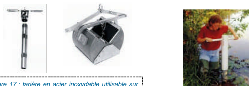
Figure 17 : tarière en acier inoxydable utilisable sur sol ; benne pour les prélèvements en immersion employée depuis une embarcation
