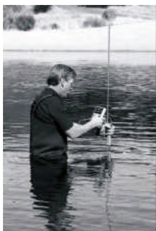
Figure 16 : La mesure ponctuelle de vitesse de courant s'effectue à l'aide de capteurs emmanchés dotés d'une hélice ou électromagnétiques. La lecture se fait sur un barillet totalisateur (vitesse moyenne sur quelques secondes) ou sur un boîtier électronique répétant la vitesse instantanée, moyenne, maximum, minimum, etc. Ces derniers peuvent être reliés à des boîtiers enregistreurs pour des mesures en continu.
