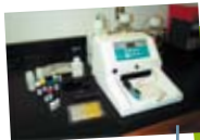
Kit d'analyse immuno-enzymatique avec son spectrophotomètre
