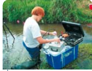
Filtration d'échantillons avant analyses à l'aide d'un kit de dosage de terrain (source FMA).
