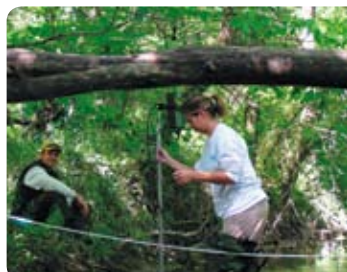
Relevés de grilles de vitesses sur une section de cours d'eau
