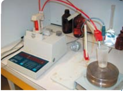
pHmètre de laboratoire pour les mesures en différé ou le contrôle métrologique (source FMA).
