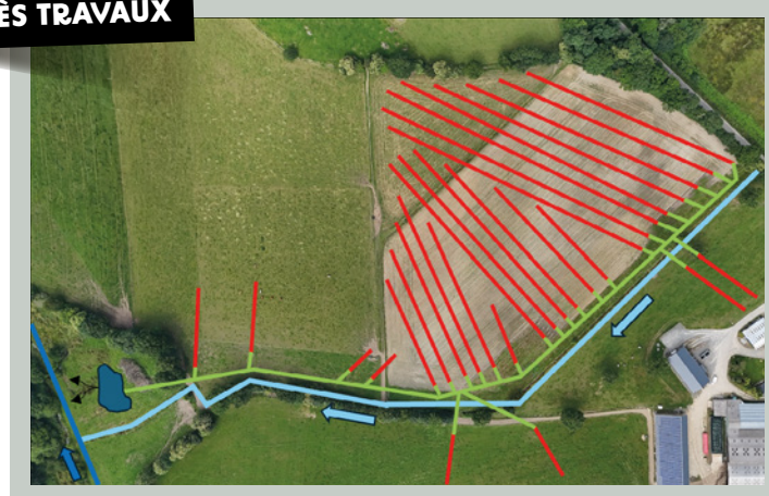
Figure 18 - Schéma de principe de la reprise de drains sur un collecteur étanche enterré et dérivation vers un bassin tampon en bas de coteau. Exemple de travaux réalisés par le Syndicat Mixte de la Loisançe et la Minette.
