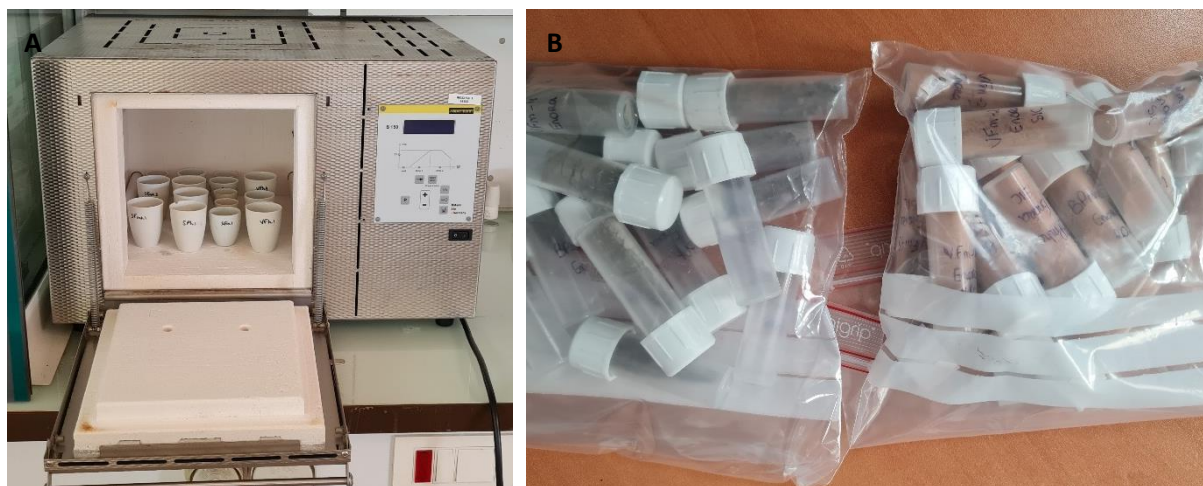
Figure 21 : A) Four à moufle et B) échantillons avant (à gauche) et après (à droite) passage au four à moufle
